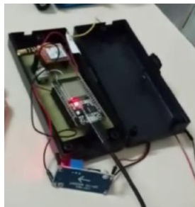
Fig. 13. Protótipo do circuito de recepção.
