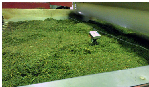
Fig. 5. Cinta transportadora al final del proceso de enrollado y principio del proceso de fermentado.
