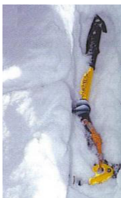
Modo correcto de colocación del Piolet curvo y cinta La cinta debe estar colocada en el centro del mango
