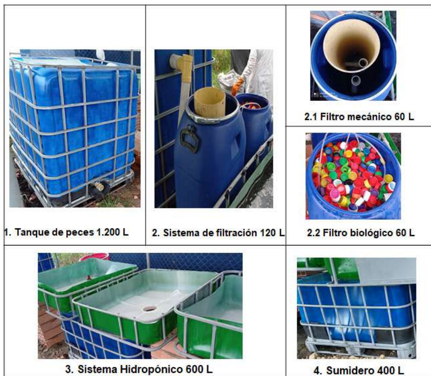
Figura 7. Componentes principales del prototipo acuapónico y su volumen en litros.
