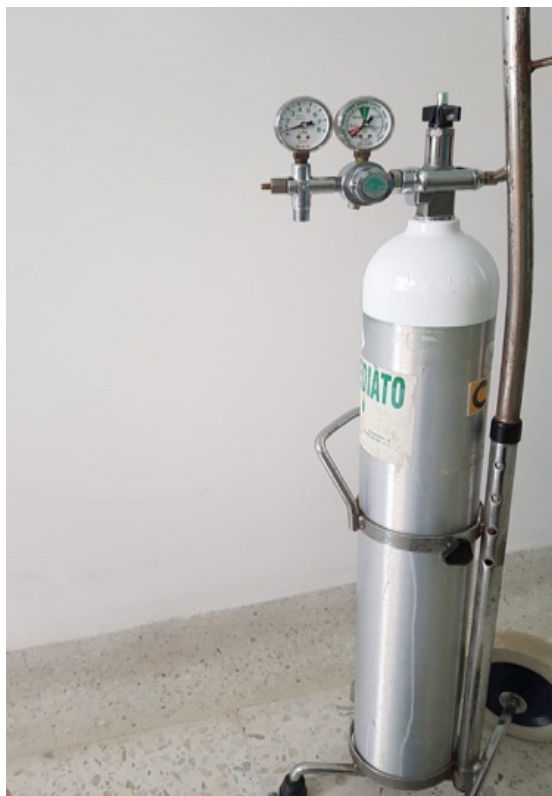
Figura 97. Manómetro y flujómetro de la bala de oxígeno.
