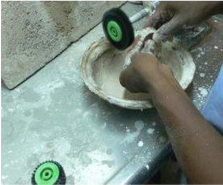
**Ilustración 274.** Se termina con un cepillo y piedra pómez en el torno de pulido. Finalmente se brilla con una felpa seca y tiza.
