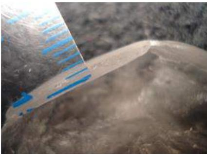
**Ilustración 225.** Calibración de la espesura del acrílico.
