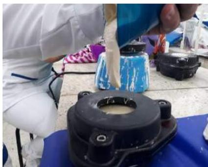
**Ilustración 278.** *Vaciado de la contratapa de la mufla.*
