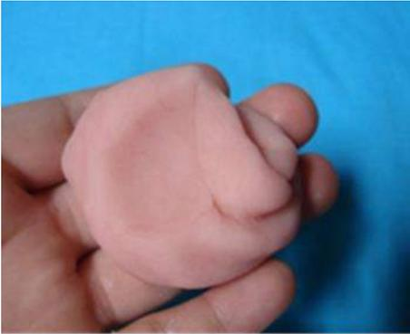
**Ilustración 265.** La etapa en la cual se manipula el acrílico, es la etapa plástica, mezclándose manualmente para eliminar todo tipo de burbujas.
