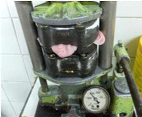
**Ilustración 267.** Se posiciona en la prensa hidráulica y se comprime hasta llegar a 1500 libras de presión.
