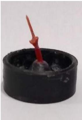
**Ilustración 195.** Patrón de núcleo colado en la peana.
