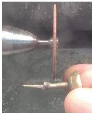
**Ilustración 198.** Corte del núcleo 1mm por encima de la unión entre el mismo y el viaducto.
