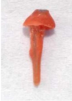
**Ilustración 193.** Patrón de núcleo sin imperfecciones
