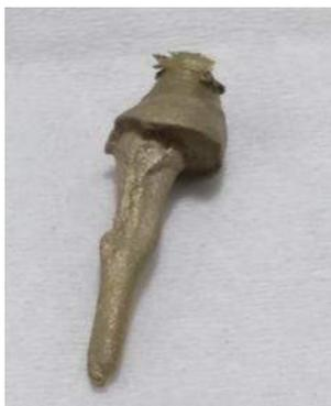
**Ilustración 199.** Núcleo fundido en el material elegido.
