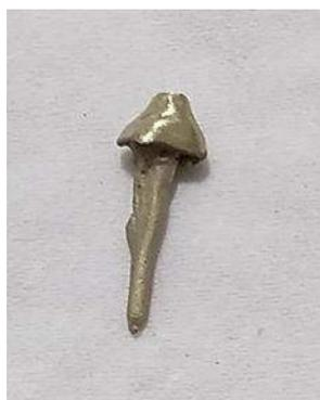
**Ilustración 200.** Núcleo pulido sin exceso de bebedero.
