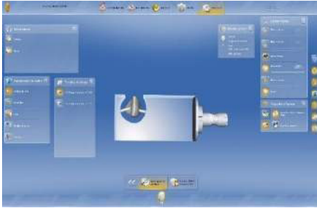
Ilustración 61. Posición de la restauración sobre el bloque, aspectos a tener en cuenta, tamaño del bloque del material, ubicación, y optimización de espacio para futuras restauraciones.
