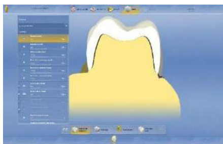
Ilustración 57. Determinación de parámetros tales como espaciador oclusal y periférico, espesura mínima, contactos interoclusales y proximales.
