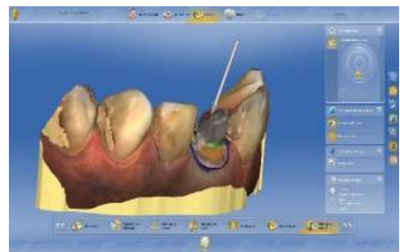
Ilustración 56. Definición del eje de inserción de la restauración, con respecto a la preparación.
