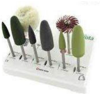
Ilustración 38. Kit de puntas de caucho abrasivas para pulimento, superficies lisas y brillantes puliendo progresivamente del color más oscuro, las más claro, seguido por cepillos duros, y felpa de lana impregnada con tiza francesa para brillo final.
