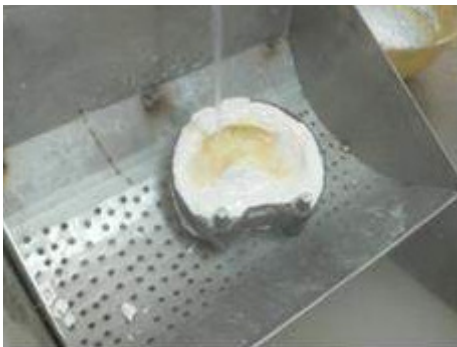
Ilustración 263. Se vierte el agua caliente hasta que quede completamente limpio de cera.
