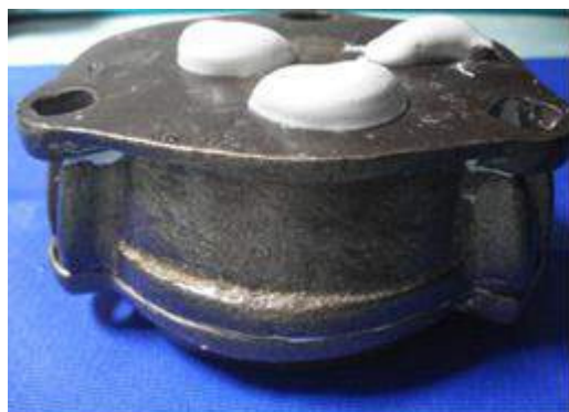
Ilustración 259. Se coloca la tapa de la mufla y se verifica que el yeso salga por los orificios que sirven de retención.
