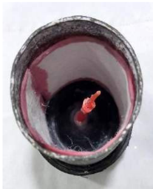
Ilustración 197. Verificación de 5mm de espacio entre la pared del anillo y el patrón de núcleo; posteriormente se realiza proceso de revestido.
