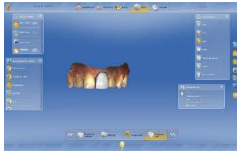
Ilustración 60. Personalización de la restauración; en este paso se puede realizar modificación de la morfología con los íconos de agregar o reducir, de acuerdo a lo requerido para terminar la restauración.
