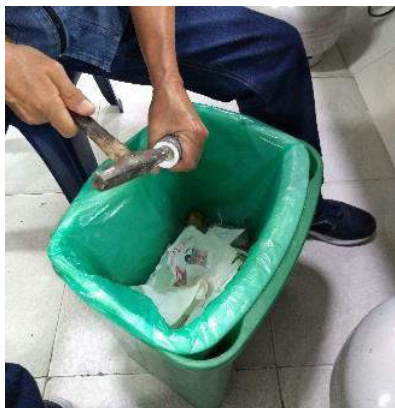
Ilustración 167. Liberación del colado de dentro del anillo.
