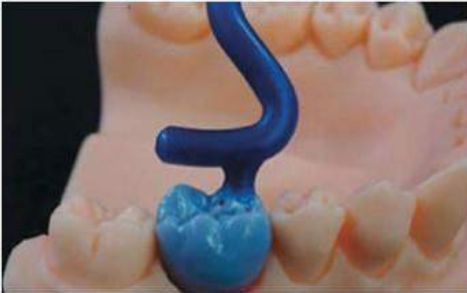
Ilustración 114. Ubicación de bebedero para una sola restauración.
