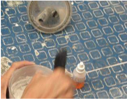
Ilustración 162. Mezclado manual de yeso.
