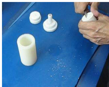
Ilustración 178. Eliminación de revestimiento del anillo.
