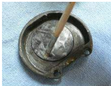
Ilustración 255. Aplicación de vaselina en toda la mufla para aislarla del yeso y facilitar el desenmuflado.
