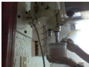
Ilustración 151. Mezcla de yeso al vacío.
