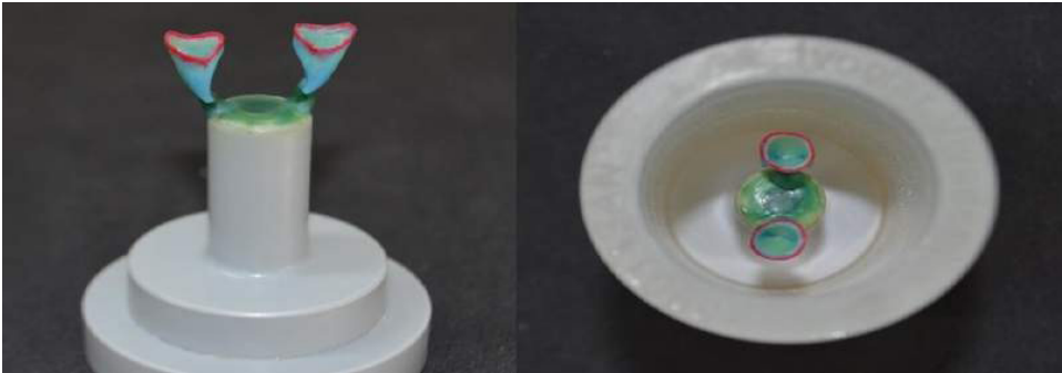
Ilustración 94. Ubicación de los patrones de cera en los bordes de la base con una angulación aproximada de 30° verificando el espacio entre los patrones de cera y las paredes del anillo de silicona para evitar fracturas durante el proceso.
