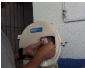
Ilustración 154. Recorte de modelo con la recortadora y agua corriente.
