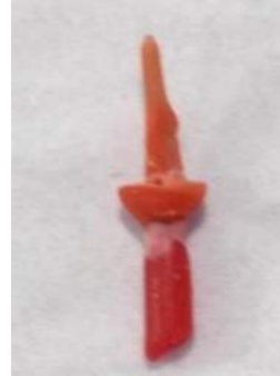
Ilustración 194. Colado del bebedero en la parte más gruesa del patrón de núcleo.
