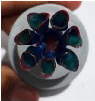
Ilustración 118. Bebederos posicionados en el anillo antes del proceso de revestido.
