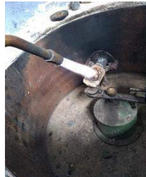
Ilustración 196. Posición del anillo en la centrifuga y posterior proceso de fundición.
