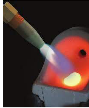
Ilustración 123. Ilustración de la llama incidiendo la aleación en el soplete.
