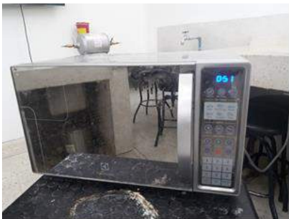
Ilustración 279. Una vez fraguado el yeso en la mufla se procede a realizar el desencerado, se introduce la mufla en el horno y se coloca una potencia máxima de 10 por minuto, cuando está listo se saca del horno, se abre y se limpia con algodones. Se introduce nuevamente en el horno con potencia de 10 por un minuto.
