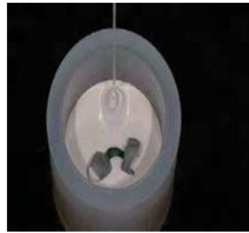
Ilustración 119. Momento de revestido del anillo.
