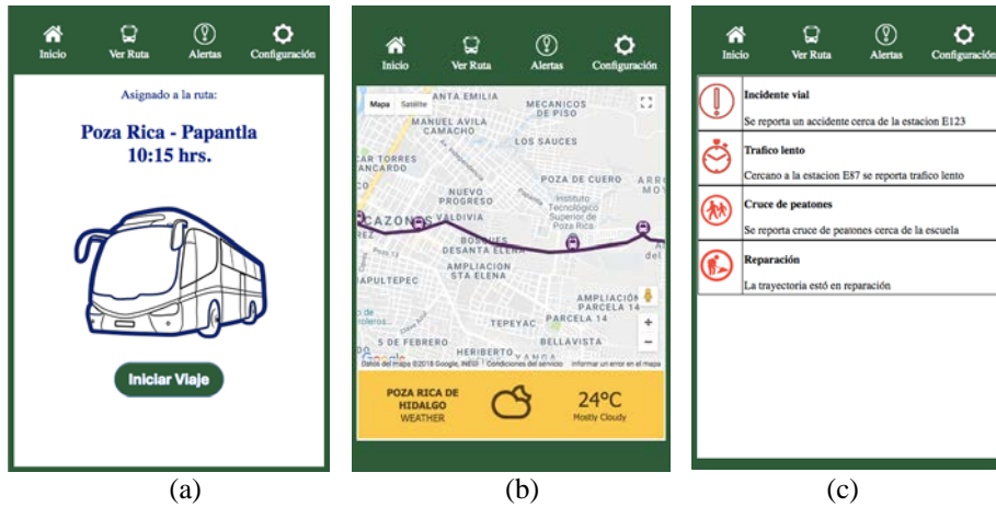
Fig. 1. Capturas de la aplicación móvil para el conductor de la unidad de transporte público: (a) inicio de un recorrido por una ruta asignada, (b) muestra de un recorrido de la ruta asignada, (c) muestra de la lista de incidentes en el recorrido.
