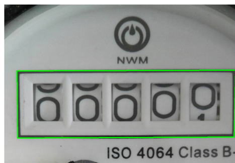
Fig. 8. Sección detectada después del filtrado por área
