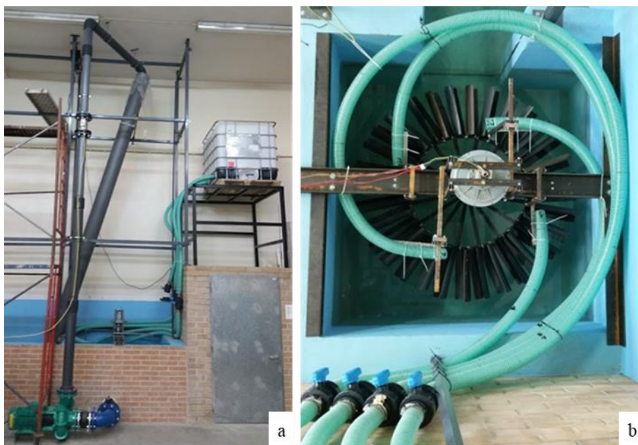
Fig. 3. a) Conjunto para emulação da cota e; b) protótipo e sua estrutura sobre o tanque.
