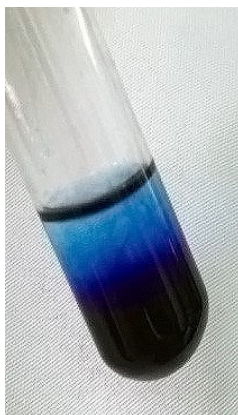
Figura 1.9.5. Reacción cobalto (II), KSCN y alcohol amílico.
