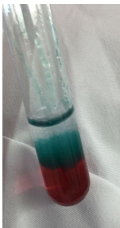
Figura 1.9.6. Reacción cobalto(II) y \text{NH}_4\text{OH} .
