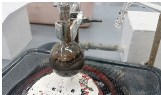
Figura 1.6.2. Residuo de cobre en el balón de destilación. Fuente: elaboración propia.
