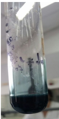
Figura 1.5.1. Reacción entre el permanganato y el hidróxido de sodio.
