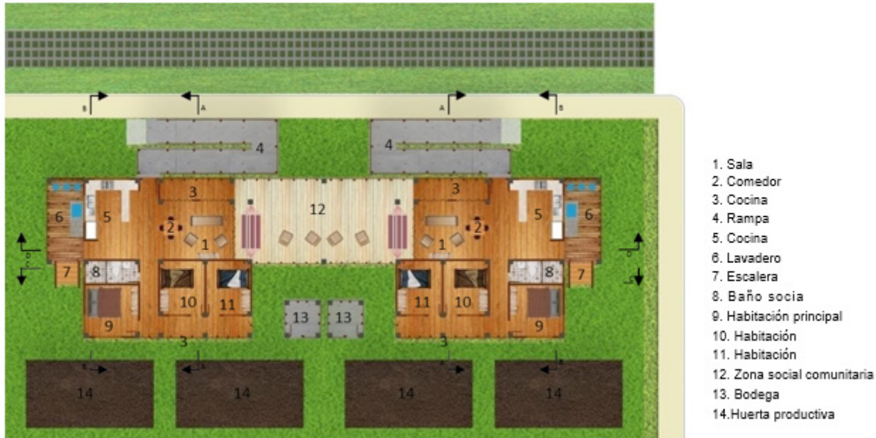
Ilustración 126: planta arquitectónica 1 nivel. Fuente: elaboración propia 2018.
